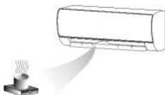
**Lassen Sie das Klimagerät nicht gegen das Heizgerät blasen.** Andernfalls führt dies zu einer unvollständigen Verbrennung und damit zu Vergiftungen
